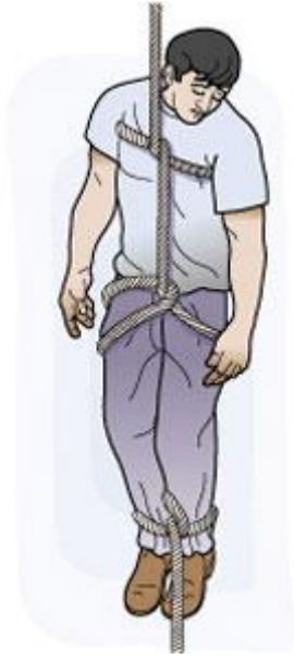
Figura: Izado con un cabo.
